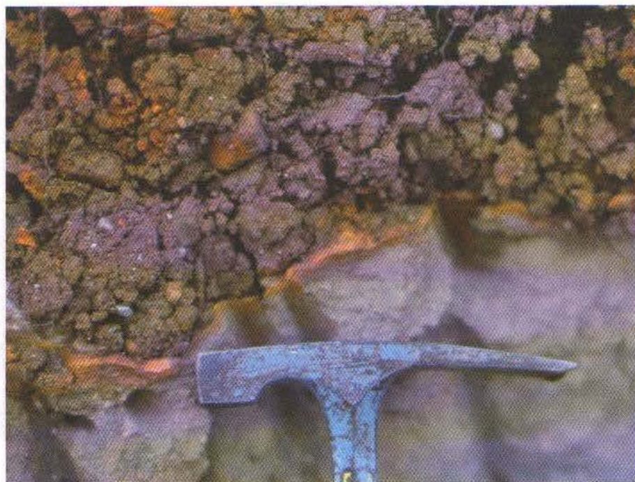
Figura 5-26. Horizonte plácico con límites abruptos entre el suelo y el sustrato. Frecuente en suelos de la Isla de Chiloé.
