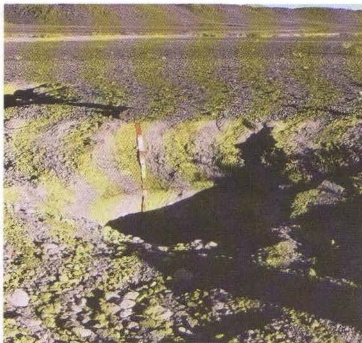
Figura 2-8. Suelo de origen volcánico, constituido por una sucesión de estratos provenientes de diferentes tefras (tanto de cenizas como de lapillis). Los estratos están constituidos por materiales de diferente composición y diferente granulometría, con límites abruptos entre ellos. Pampa del Avestruz, camino de Calama a Ollagüe.
