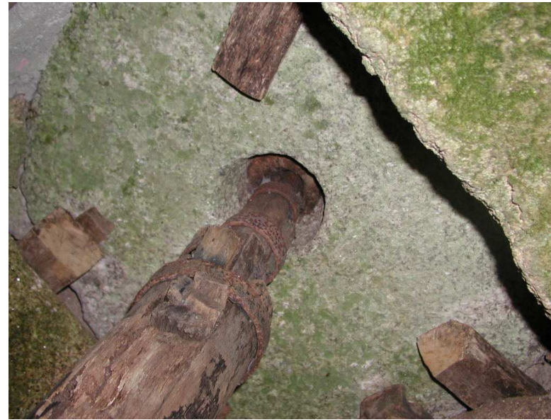
Detalle del lobete con anilhas , cunhas y veio . En el interior del ojo de la mó, se puede observarla bucha
