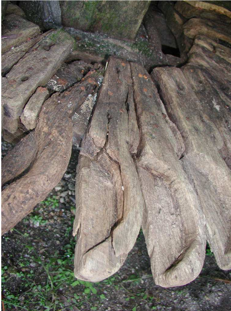
Detalle de las penas del rodízio con forma de cucharas. Molino n.º 2
