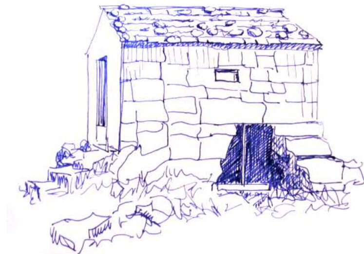
Dibujo superior: molino n.º 4 donde se observa el socaz en el cabouço
