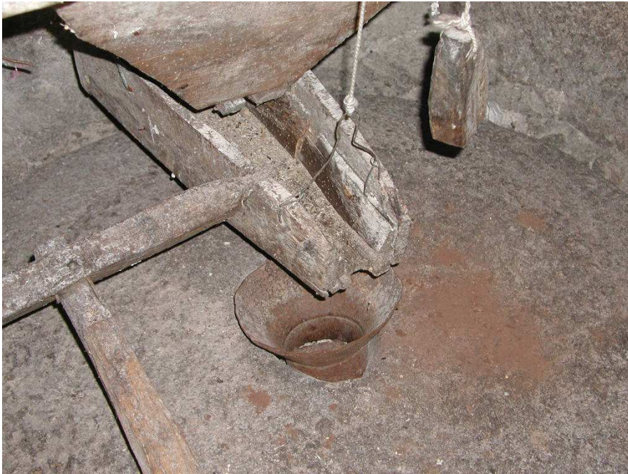
Detalle de olho da mó andadeira , tingideiro y quelha . Molino n. 92
