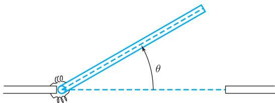
Figura 4.10 Vista superior de una puerta de doble acción
