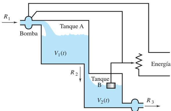
Figura 5.3 Sistema de retroalimentación con retraso acumulado
