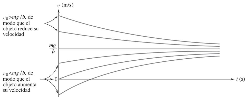
**Figura 2.2** Gráfica de  $v(t)$  para seis velocidades iniciales distintas  $v_0$ . ( $g = 9.8 \text{ m/s}^2$ ,  $m/b = 5 \text{ s}$ )
