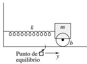
Figura 4.1 Oscilador masa-resorte amortiguado
