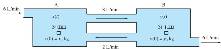
Figura 5.1 Tanques interconectados
