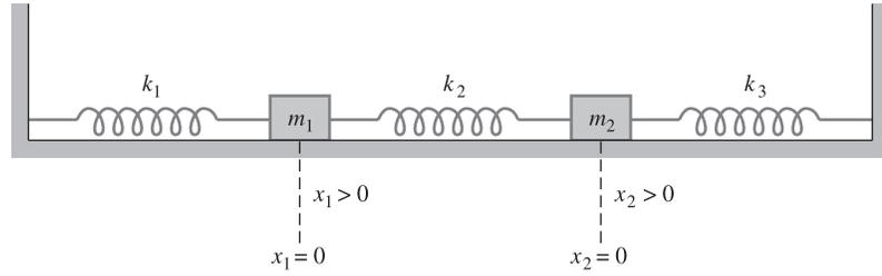
Figura 9.5 Sistema acoplado masa-resorte con extremos fijos
