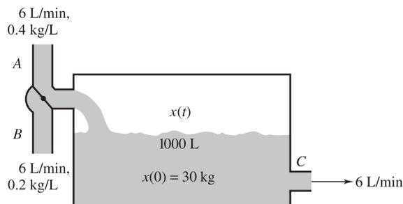
Figura 7.1 Tanque mezclador con la válvula  $A$  abierta
