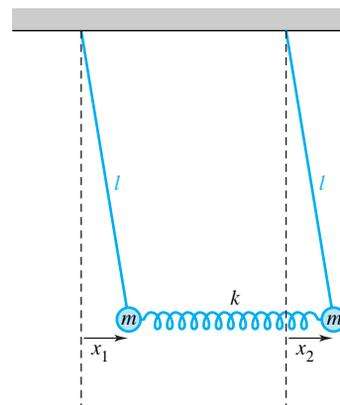
Figura 5.30 Péndulos acoplados
