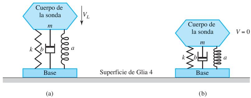
**Figura 5.48** Esquema del sistema de aterrizaje de una sonda. (a) El sistema al momento del impacto. Los resortes no están estirados ni comprimidos, los propulsores se han apagado y la velocidad es  $V_L$  hacia abajo. (b) La sonda ha alcanzado un estado de reposo sobre la superficie, y los resortes se han comprimido lo suficiente para soportar el peso. Entre los estados (a) y (b), la sonda oscila con respecto de su base.
