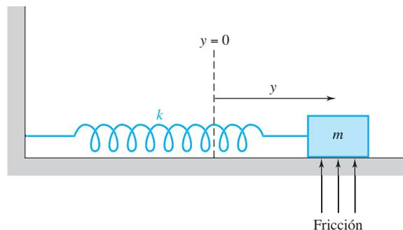
Figura 5.18 Sistema masa-resorte con fricción
