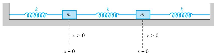
Figura 5.23 Sistema masa-resorte acoplado con extremos fijos
