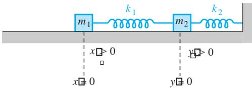
Figura 5.25 Sistema masa-resorte acoplado con un extremo libre
