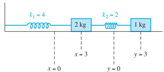
Figura 5.21 Sistema acoplado en su desplazamiento inicial
