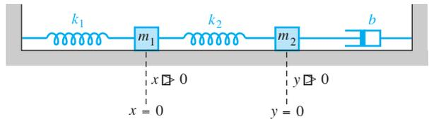
Figura 5.27 Sistema masa-resorte acoplado con un extremo amortiguado
