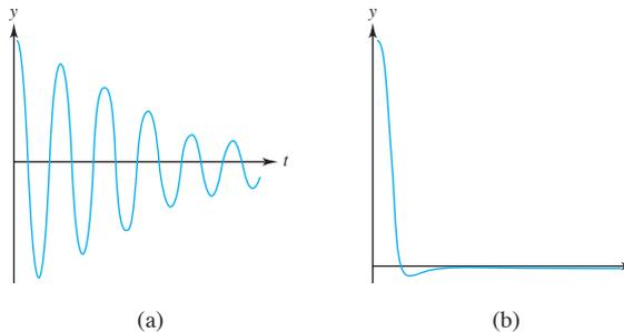
**Figura 4.3** (a) Fricción baja y (b) fricción alta
