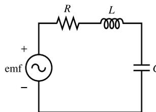
Figura 1.3 Diagrama de un circuito RLC en serie
