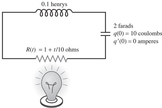
**Figura 8.5** Un circuito  $RLC$  cuya resistencia se calienta
