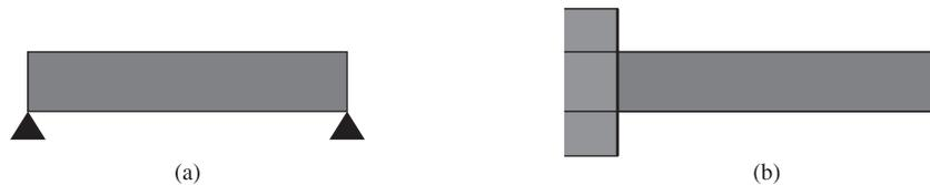
**Figura 11.3** Viga apoyada de manera simple (a) y una viga voladiza (b)
