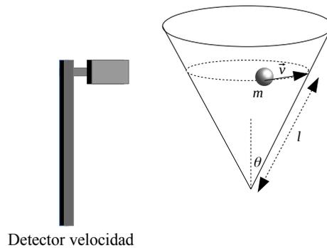
Figura 1: Esquema básico del montaje de aceleración centrípeta
