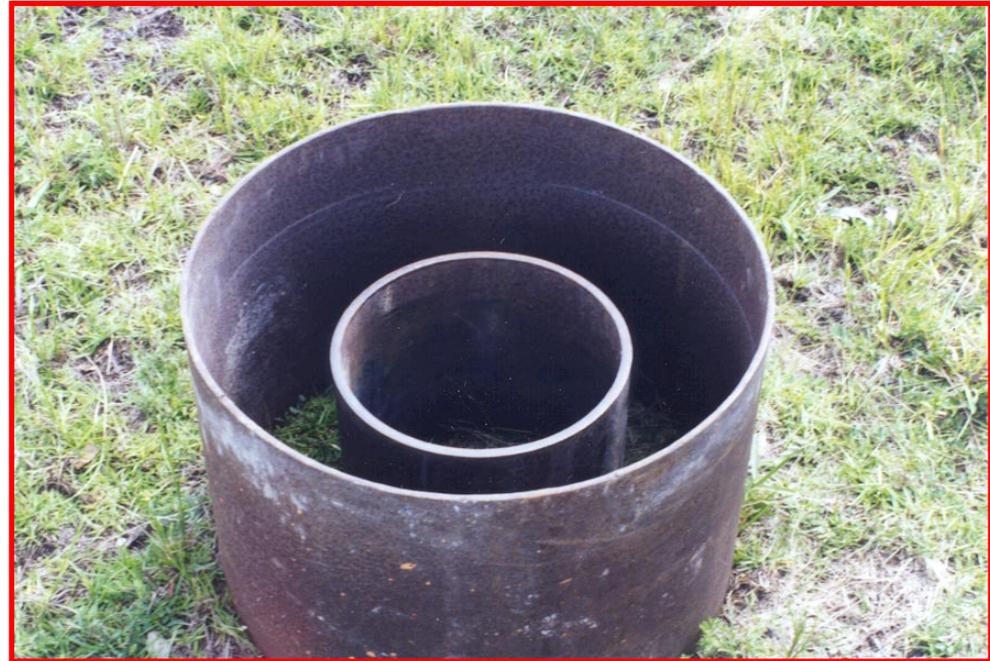
La figura muestra un ejemplo de infiltrómetro doble, en el cual se incorpora agua en el anillo exterior y se deja infiltrar durante un tiempo muy largo para saturar la porción externa del suelo, luego se realiza una prueba de infiltración en el tubo interior.
