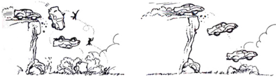
Figura VI.16: La forma como cae un automóvil en un abismo depende de la aceleración que le imprima el conductor en los segundos previos a la caída: si no acelera cae rotando (Figura izquierda), si acelera no rota (Figura derecha).
