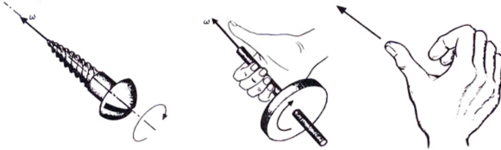
Figura VI.2: Uso de la regla de la mano derecha. Es una convención usada frecuentemente y por lo tanto conviene no olvidar. Entre sus aplicaciones permite asociar un vector a la velocidad angular \omega .
