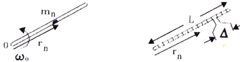
Figura VI.25: Descomposición de una barra continua en elementos muy pequeños que finalmente, en el cálculo, son considerados como partículas puntuales.
