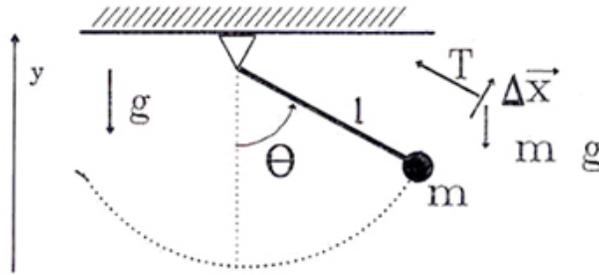
Figura X.8: En el movimiento del péndulo la tensión no realiza trabajo. Sólo la componente vertical del desplazamiento lo hace debido a la fuerza gravitacional.
