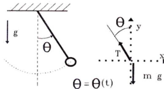
Figura IX.5: Una masa  $m$  suspendida de una cuerda de largo  $\ell$ , oscila en un campo gravitatorio. Se incluye el diagrama de cuerpo libre de la masa  $m$ . El ángulo  $\theta$  debe ser del orden de  $5^\circ$  para usar la aproximación  $\text{sen } \theta \approx \theta$ .
