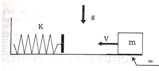
Figura X.7: El resorte está inicialmente con su largo natural y la masa  $m$  se acerca con velocidad  $V$ . La energía no se conserva debido a la existencia de roce entre el piso y la masa. La energía disipada es igual al trabajo que realiza la fuerza de roce.
