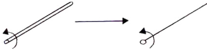
Figura XIV.3: Modelo usado para calcular el momento angular de una barra rígida. En rigor, este modelo identifica la barra con un segmento de una línea recta: no consideramos su ancho. Incluirlo complica el álgebra y no agrega nada conceptualmente nuevo.
