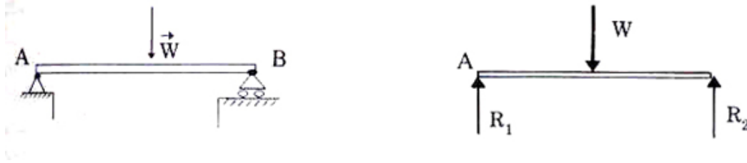
Figura XIII.11: Modelo de la viga soportada en sus extremos por una unión fija y otra deslizante. A la derecha se incluye el diagrama de cuerpo libre de la estructura.
