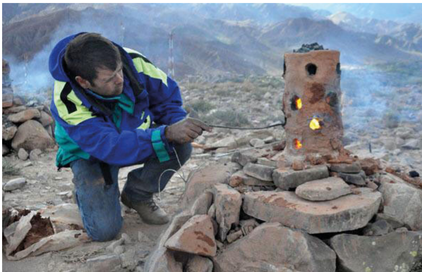
Recreación de la práctica precolombina de fundir cobre utilizando hornos de viento a altas temperaturas.
