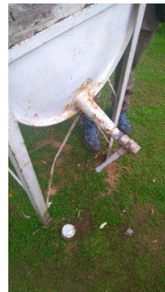
Figuras 12 y 13. Destilador solar para la miel. A ras de suelo y formato mesa. La boquilla permite controlar la caída de miel una vez se finaliza el proceso. Fuente: Elaboración propia., 2016
