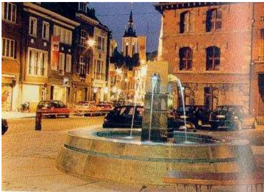
FUENTE DE LA PORTE DE LILLE, LOS SURTIDORES DE AGUA ESTAN ILUMINADOS CON FIBRA OPTICA. UN GENERADOR OCTOPUS CON 16 CABLES DE 5 MM DE DIAMETRO CON UN LENTE
