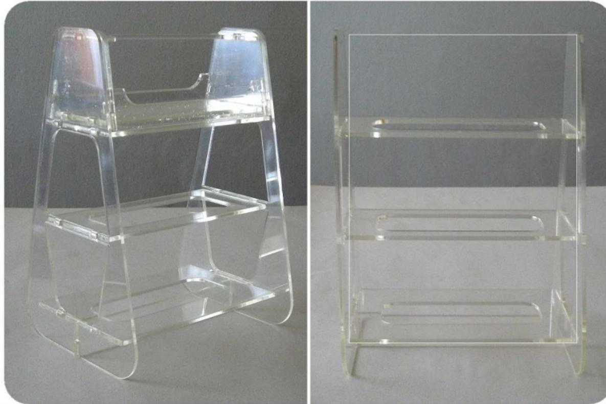
IMAGEN 1. El modelo tiende a desestabilizarse por el contacto deficiente entre las caras internas de los conectores.
