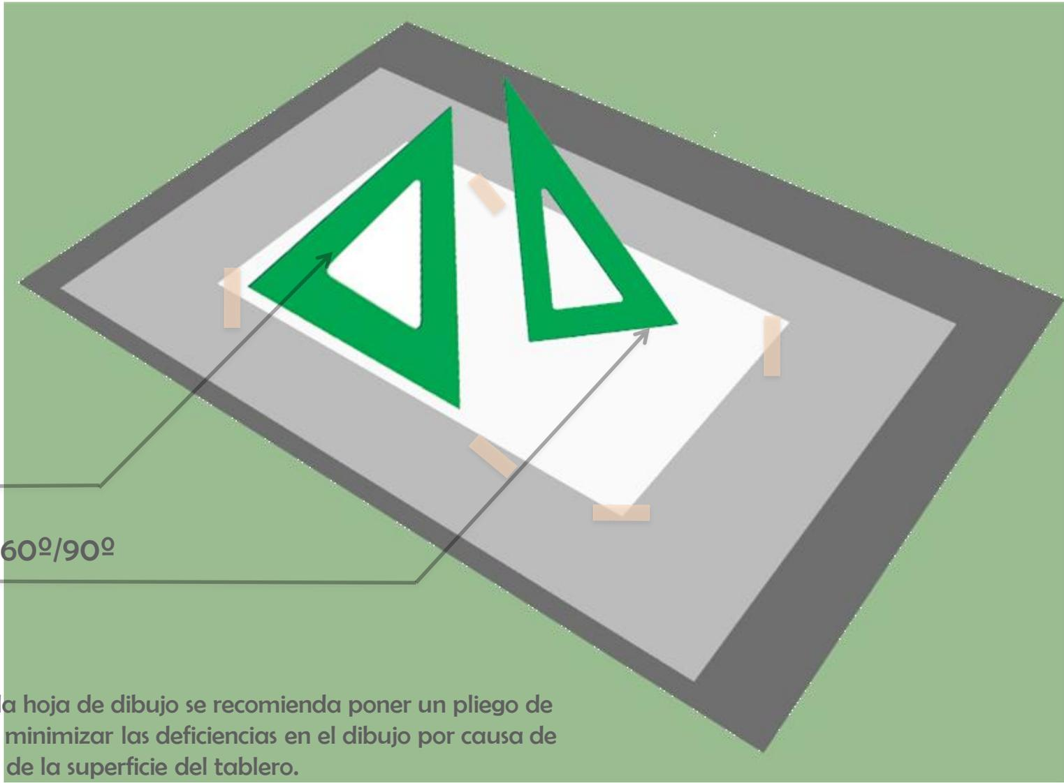
Entre el tablero y la hoja de dibujo se recomienda poner un pliego de papel hilado para minimizar las deficiencias en el dibujo por causa de las irregularidades de la superficie del tablero.
