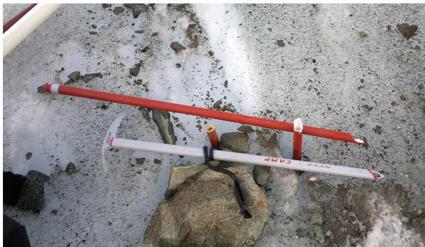
Figura 44. BALIZA DE POLIPROPILENO ROTA POR UN RODADO. GLACIAR MARTIAL ESTE, ARGENTINA. Fuente: Rodolfo Iturraspe.
