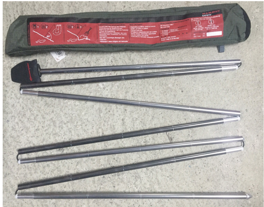
Figura 51. SONDA DE NIEVE. SE OBSERVAN SEGMENTOS QUE SE PUEDEN AGREGAR PARA MEDIR HASTA UNA CAPA DE NIEVE MÁS DENSA EN PROFUNDIDAD. Fuente: CECs.
