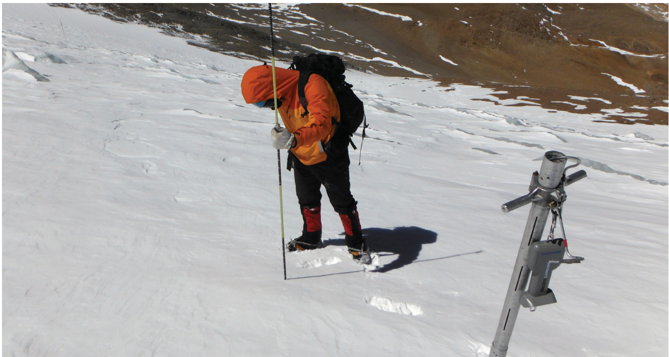
Figura 52. MEDICIONES CON SONDAS DE NIEVE EN GLACIAR ORTIGAS 1, CHILE SEMIÁRIDO. Fuente: Camilo Muñoz.
