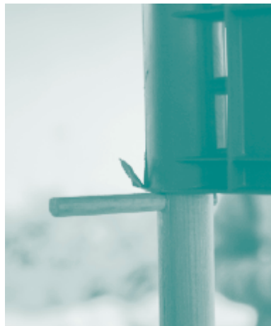
Huerto CULTIVA en CENTRO. Demostración de ensamblaje de cajas con palos de madera y taquete para sujeción. Hub de diseño social, 2017.
