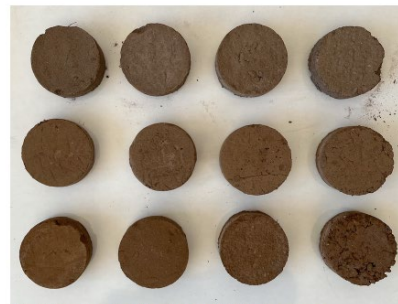
Figura 13. Muestras de etapa uno. Fila de arriba abajo: tierra Peñololén, Linares, Pomaire. Columna de izquierda a derecha: arena fina 1:1, arena fina 1:2, arena gruesa 1:1, arena gruesa 1:2. Fuente: Elaboración propia
