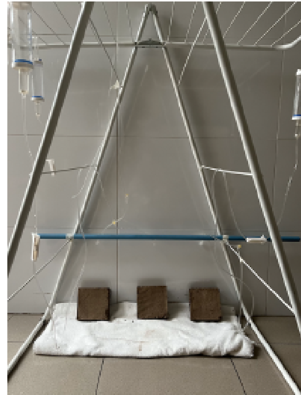
Figura 19. Montaje para ensayo de goteo.
