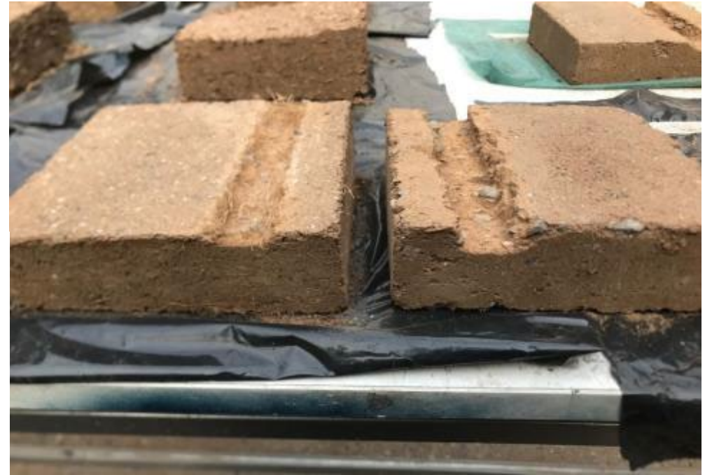
Figura 31: izq. Muestra con aditivo después de hacer el primer ensayo. Der. Muestra sin aditivo después de realizar el ensayo
