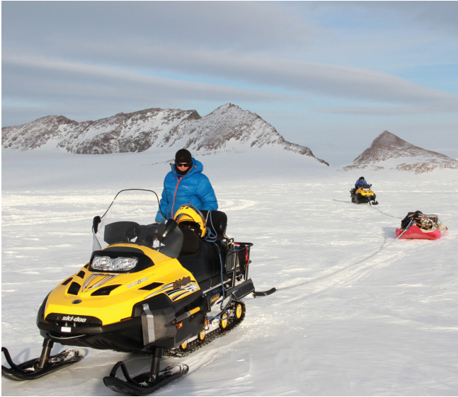
Figura 67. CUERDA DINÁMICA CONECTADA ENTRE EL ARNÉS DEL CONDUCTOR Y SU MOTO. Fuente: Tim Hewette.
