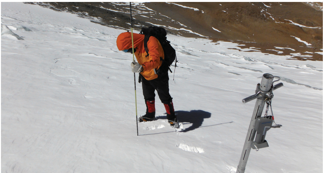
Figura 52. MEDICIONES CON SONDAS DE NIEVE EN GLACIAR ORTIGAS 1, CHILE SEMIÁRIDO. Fuente: Camilo Muñoz.
