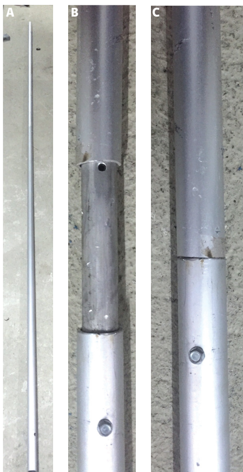
Figura 39. ACERCAMIENTO AL SISTEMA DE UNIÓN DE BALIZAS DE ALUMINIO POR COPLAS. A) BALIZA COMPLETA, B) DETALLE DEL SISTEMA DE COPLA Y C) DETALLE DEL SISTEMA DE UNIÓN DE SEGMENTOS. Fuente: CECs.
