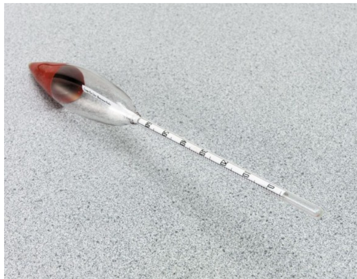
Figura 10: Típico hidrómetro para suelos. Este aparato determina la densidad de la suspensión de suelo y está precalibrado para su utilización en ciencias del suelo.
