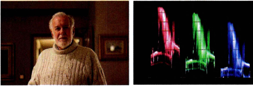
Figura 7.18. Imagen con fuerte dominante cálida. Se puede observar en el RGB parade que las formas de onda de las componentes de color no están alineadas
