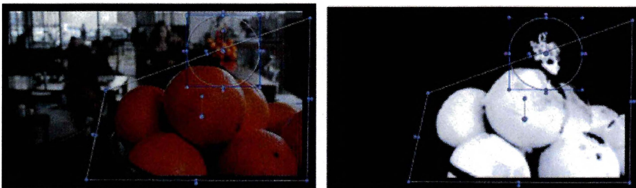
Figura 7.28. Con dos máscaras geométricas se ha delimitado la zona de actuación del HSL Qualifier
