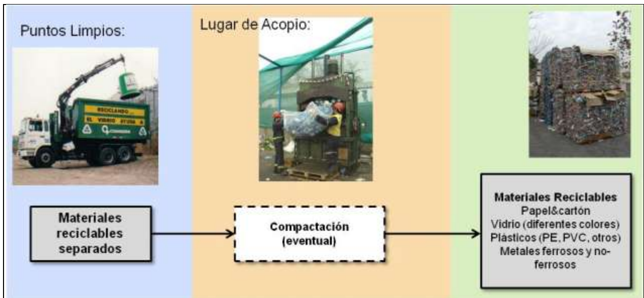
GRAFICO RE-3.2: ESQUEMA DE FUNCIONAMIENTO DE UN SISTEMA DE ENTREGA / "PUNTOS LIMPIOS" (ALTERNATIVA A)
