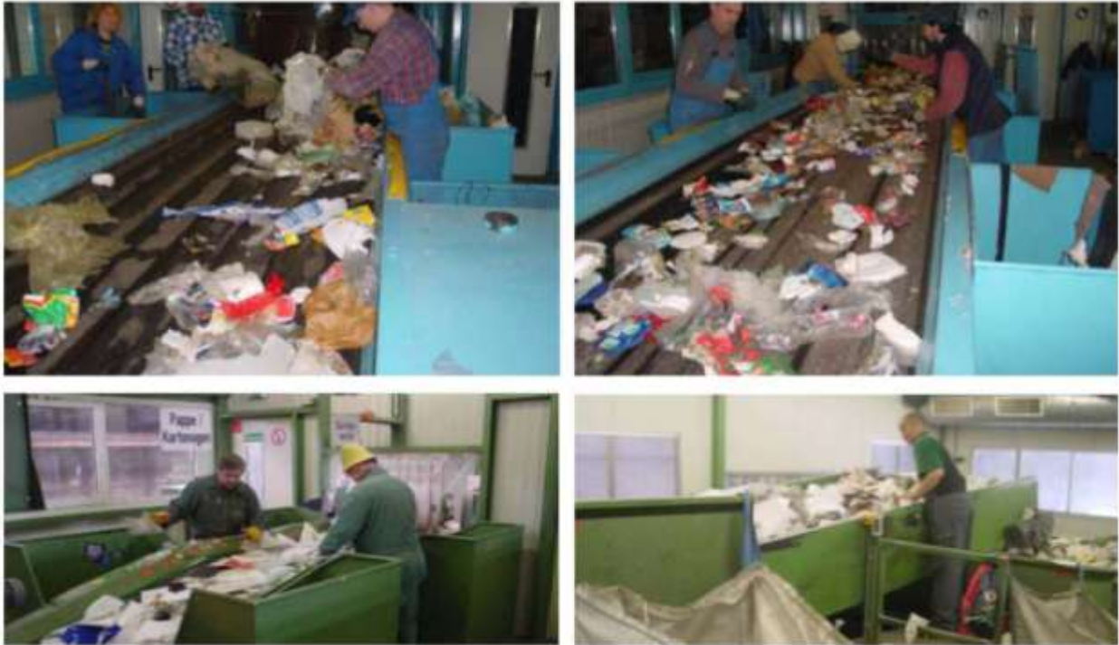
GRAFICO RE-3.6: EJEMPLOS DE SISTEMAS DE CLASIFICACIÓN MANUAL DE RESIDUOS
