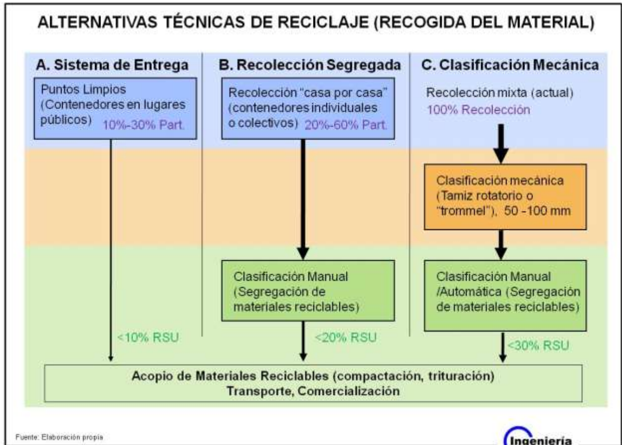
GRAFICO RE-3.1: ALTERNATIVAS TÉCNICAS DE RECICLAJE (RECOGIDA DEL MATERIAL)
