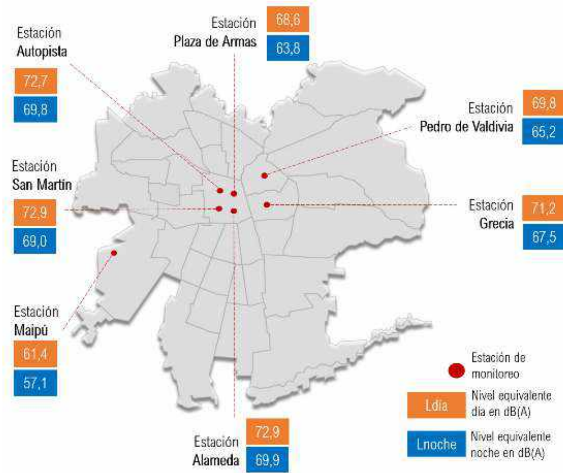
Figura 6. Niveles obtenidos por estación de la Red de Monitoreo de Ruido Ambiental del Gran Santiago
