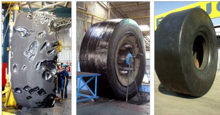
Figura 37. Recauchaje de Neumáticos Mineros
