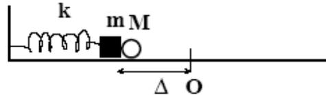
135. En la figura se muestra un carro de masa  $m$  que se mueve sin fricción sobre una superficie horizontal pulida con rapidez  $V$  hacia la derecha. El carro lleva en su parte delantera un parachoques formado por un resorte de constante elástica  $k$  con el cual choca contra la pared. El contacto entre la pared y el carro queda regido por el comportamiento del resorte.
