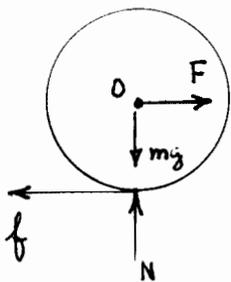
$$\begin{array}{l} \left. \begin{array}{l} (1) F - f = m a_{ox} \\ (2) N - mg = 0 \end{array} \right\} \begin{array}{l} \text{Movimiento} \\ \text{del C. de masa O.} \end{array} \\ z_o: \quad (3) f \cdot R = I_o \alpha \quad \text{Ecuación rotacional} \\ (4) a_{ox} = R \alpha \quad \text{En cinemática.} \end{array}$$
