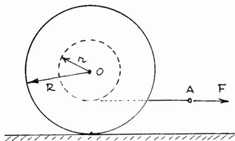
un carrete de masa  $m$  y radios  $R$  y  $r$ , tiene un momento de inercia  $I_0$  relativo a su eje de simetría. Se aplica una fuerza horizontal constante  $F$  mediante un hilo ideal enrollado en su cilindro interior. Si la rugosidad del plano fijo horizontal sobre el cual se apoya el carrete
