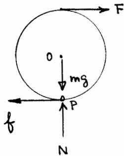
Obtenemos de inmediato la aceleración  $a_{0x} = R\alpha$  mediante la ecuación rotacional.  $\tau_P = I_P \alpha$
