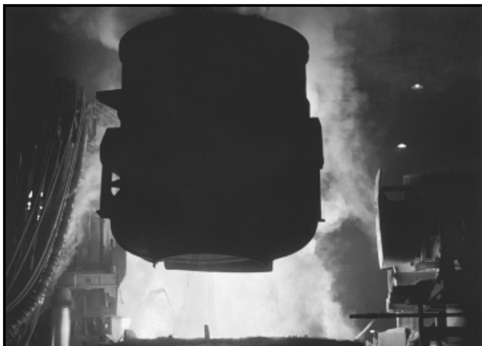
Operación de carga de horno eléctrico, Planta Colina Gerdau AZA.
