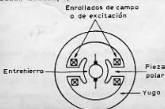
Fig. 6: Circuito de excitación de una máquina de dos polos.
