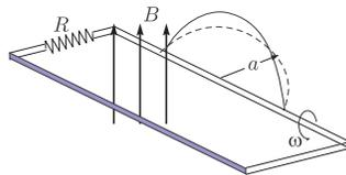
**Problema 2.** Un alambre de largo  $l$  y de sección cuadrada con masa  $m$  y resistencia eléctrica nula se desliza sin fricción sobre un par de carriles conductores paralelos de resistencia eléctrica total  $R$ . El plano de los carriles forma un ángulo  $\alpha$  con la horizontal y el sistema se encuentra en presencia de un campo magnético uniforme vertical tal como se muestra en la figura. ¿Cuál es la velocidad constante del alambre?
