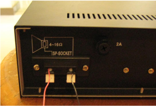
Figura 2: (A) Conexión de salida del amplificador, que puede ir hacia la tarjeta de adquisición o al osciloscopio. (B) Conexión de cables con la tarjeta de adquisición, en modo referencia simple (usando canales GND y AI0 por ejemplo).
