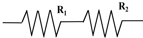
Fig. 1: Resistencias en serie
