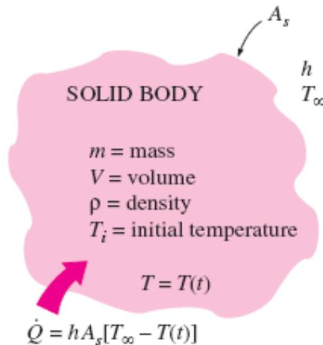
En  $t = 0$  el sólido se coloca en un medio a  $T_\infty$
