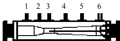
Figura 6.2. Tubo de Venturi.
