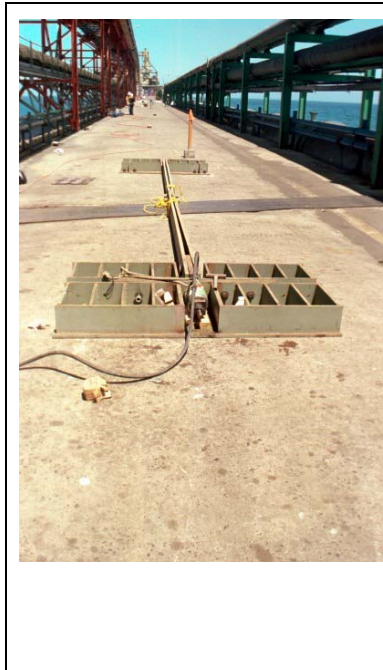
Figura 6.2 Sistema de tiro para provocar desplazamiento inicial en Muelle de ventanas
