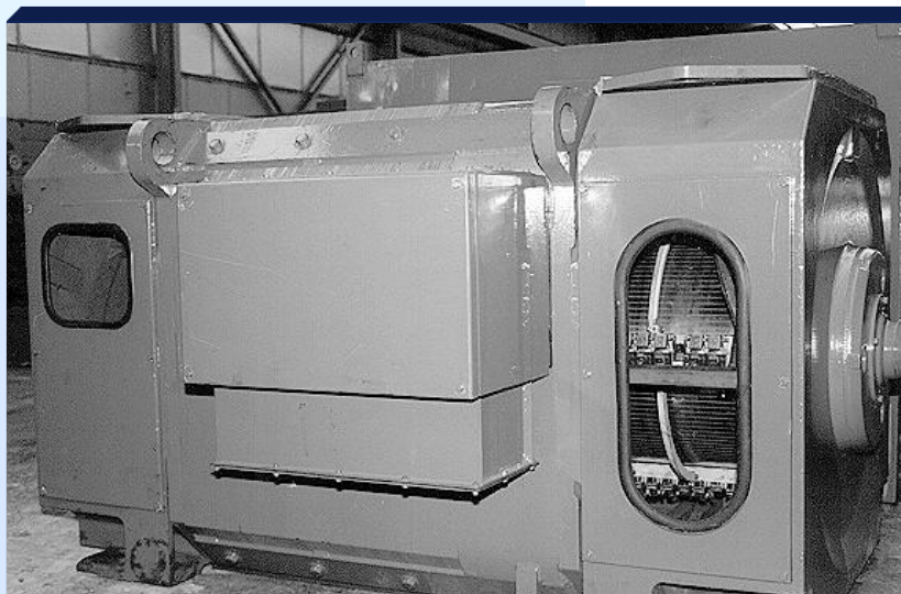
Motor de CC de 6000 kW fabricado por ABB
