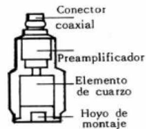
Acelerómetro con preamplificador incorporado.
