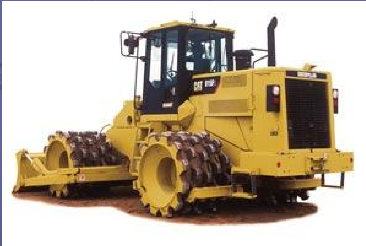
Compactador pata de cabra (20 tons)
