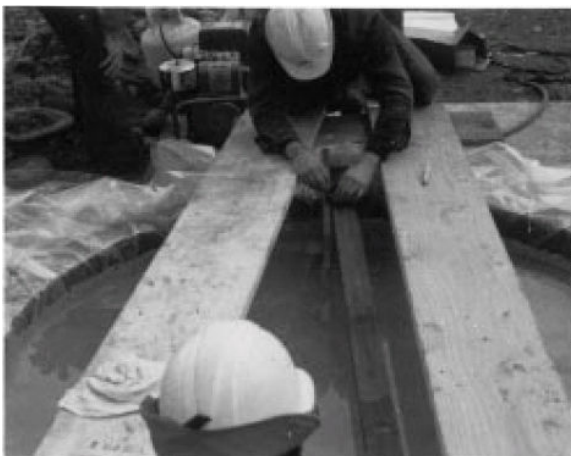
Figura 15. Medición de densidad in situ en suelos con partículas grandes.
