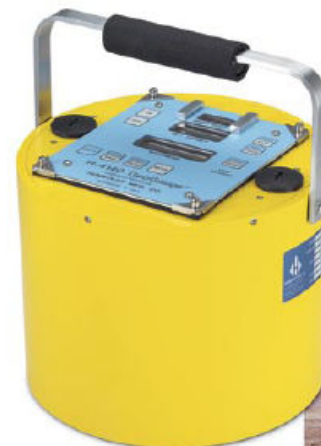
Figura 18. Equipo de control mediante carga dinámica.
