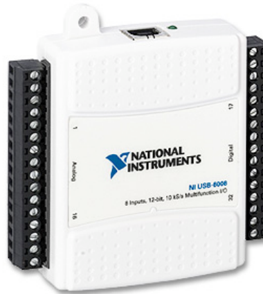
Figura 3: Tarjeta de adquisición National Instruments , modelo NI USB-6008. A la izquierda se observa la columna de canales análogos, que son los que usaremos en este curso.
