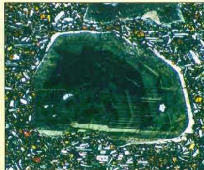
◀ Figura 4.B Fotomicrografía de un cristal de plagioclasa dividido en zonas. Después de la solidificación de este cristal (compuesto por feldespato rico en calcio), un enfriamiento ulterior provocaría que los iones sodio desplazarán los iones calcio. Dado que no se completó la sustitución, este cristal de feldespato tiene un interior rico en calcio rodeado por zonas progresivamente más ricas en sodio. (Foto de E. J. Tarbuck.)
