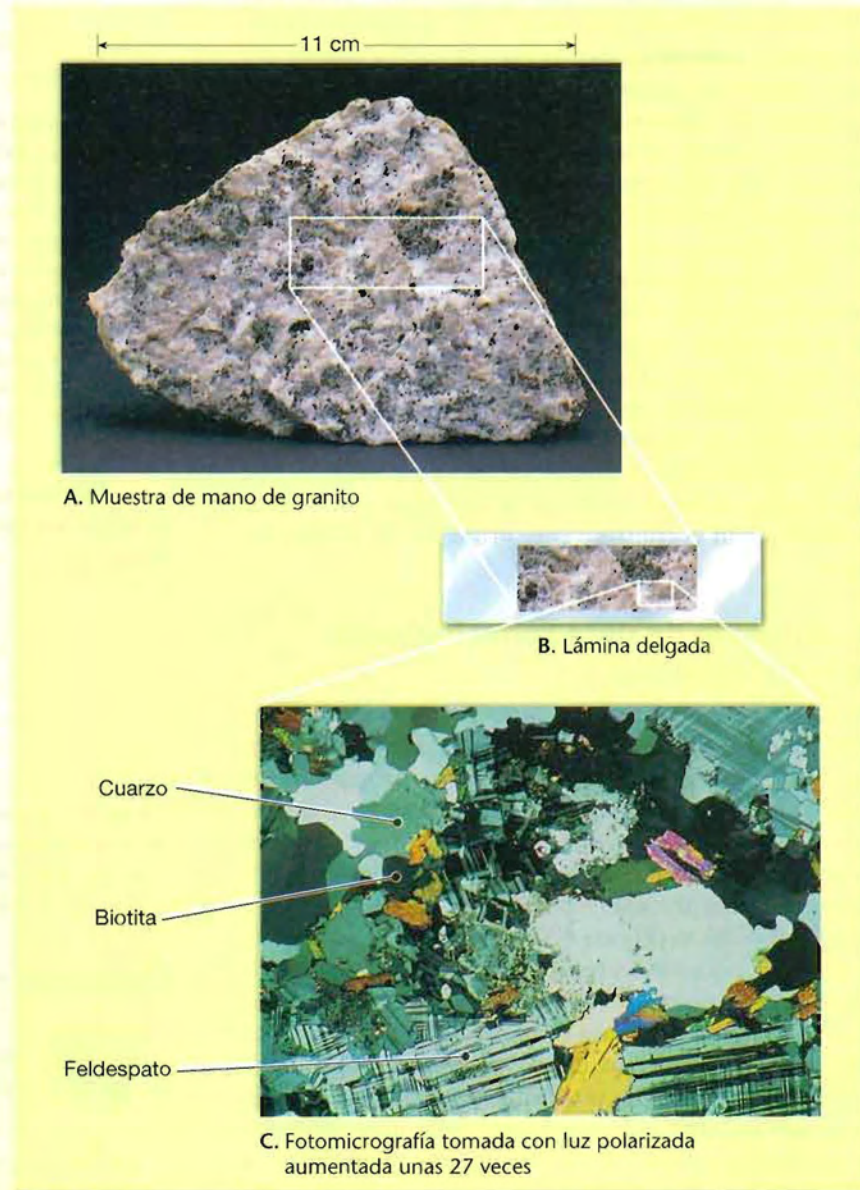
▲ Figura 4.A Las secciones o láminas delgadas son muy útiles en la identificación de los componentes minerales de las rocas. A. A partir de la muestra de mano se corta una porción plana mediante una sierra de diamante. B. Esta porción se pega a un portaobjetos siendo sometida a desbaste hasta hacerse transparente a la luz (aproximadamente 0,03 mm de grosor). Esta porción muy fina de roca se denomina sección o lámina delgada. C. Lámina delgada de granito observada con luz polarizada. (Fotos de E. J. Tarbuck.)
