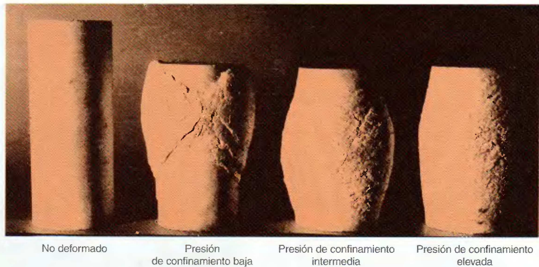
▲ Figura 10.4 Cilindro de mármol deformado en el laboratorio mediante la aplicación de miles de kilogramos de peso desde arriba. Cada muestra se deformó en un entorno que duplicaba la presión de confinamiento hallada a distintas profundidades. Obsérvese que cuando la presión de confinamiento era baja, la muestra se deformó por fractura frágil, mientras que cuando la presión de confinamiento era elevada, la muestra se deformó plásticamente. (Foto cortesía de M. S. Patterson, Australian National University.)
