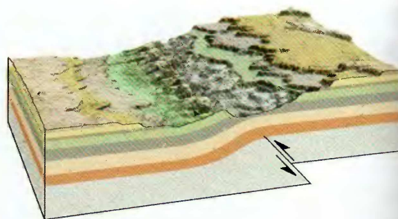
▲ Figura 10.12 Monoclinal. El monoclinal consiste en estratos sedimentarios plegados que fueron deformados por una fractura del basamento. El cabalgamiento de este diagrama se denomina cabalgamiento ciego porque no alcanza la superficie.
