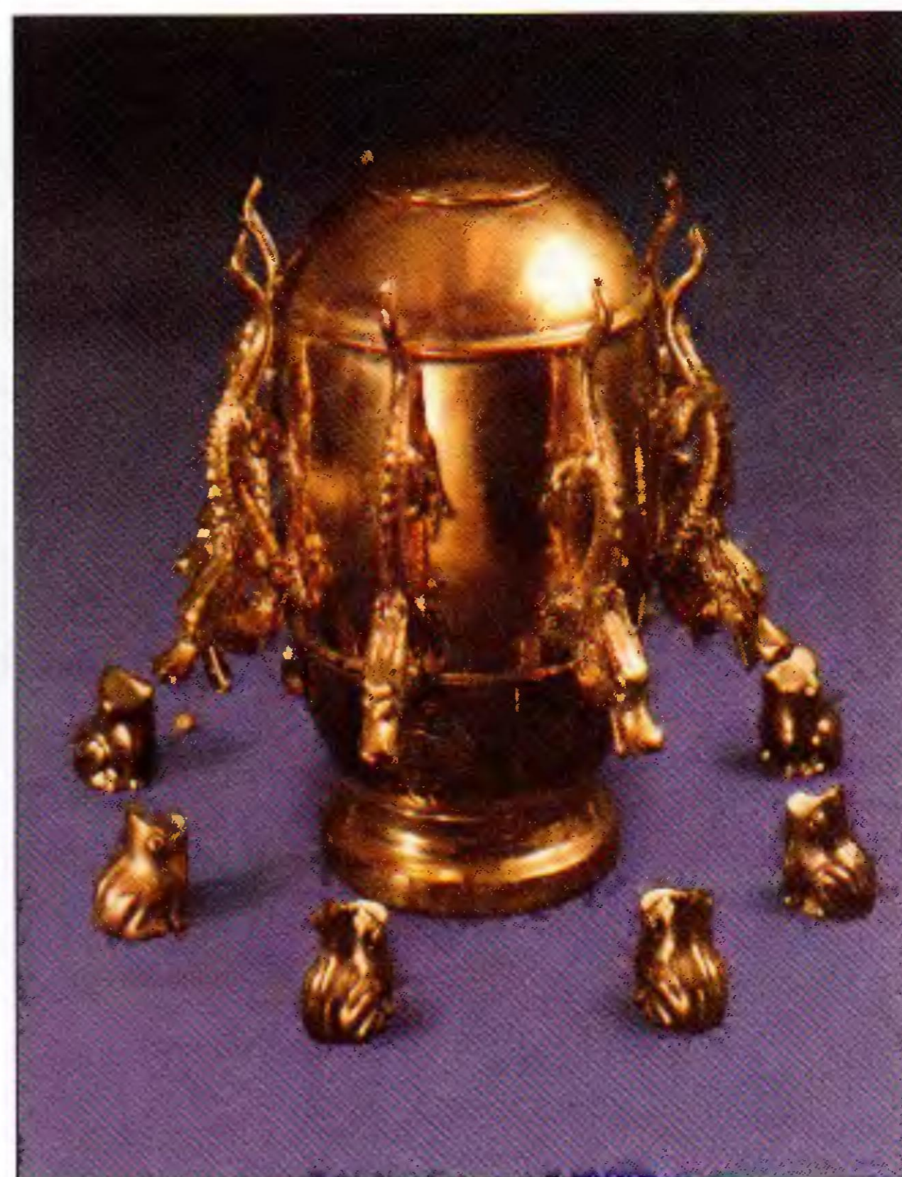
▲ Figura 11.5 Antigo sismógrafo chino. Durante un temblor de tierra, los dragones situados en la dirección de las vibraciones principales tiraban una bola en las bocas de las ranas de abajo.
