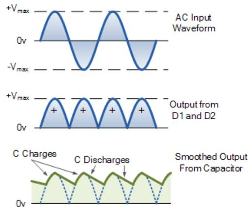
Figura 2: Rectificación de onda completa.
