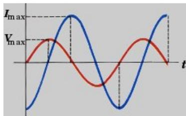
Figura 1: Voltaje que adelanta a la corriente.
