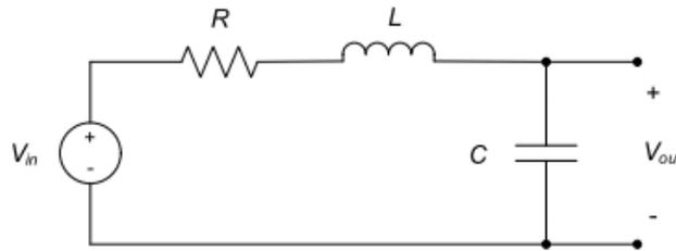
Figura 4: Circuito Equivalente RLC serie.
