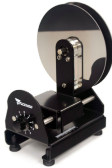
Figura 1: Condensador de placas planas.
