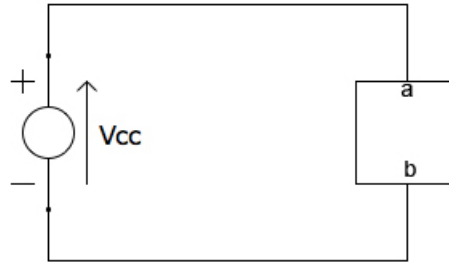
Figura 1.2: Esquema de un circuito compuesto por una fuente de voltaje continuo y una “caja” que utiliza la energía eléctrica.
