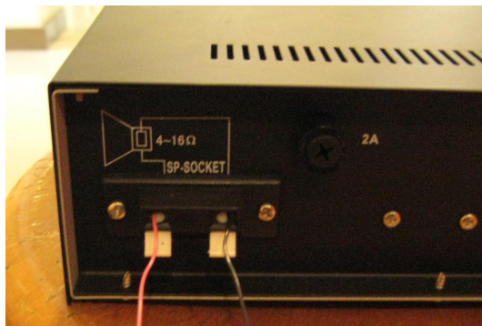
Figura 7.2: Izquierda: Conexión de salida del amplificador. Derecha: Conexión de cables con la tarjeta de adquisición.
