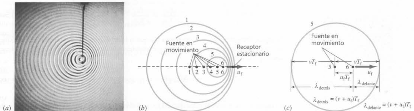
Figura 15.24 (a) Ondas en una cubeta de ondas producidas por un foco puntual que se mueve hacia la derecha. Los frentes de onda se encuentran más próximos delante del foco y más separados detrás de él. (b) Frentes de onda sucesivos emitidos por un foco puntual que se mueve hacia la derecha con velocidad u_f . Cada uno de los frentes numerados fue emitido cuando el foco estaba en la posición a la que corresponde el mismo número. (c) Durante el tiempo T_f la fuente se mueve una distancia u_f T_f y el 5º frente se mueve una distancia v T_f . Delante de la fuente la longitud de onda es \lambda_{\text{delante}} = (v - u_f) T_f y detrás de ésta, \lambda_{\text{detrás}} = (v + u_f) T_f .
