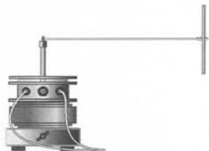
Figura 16.14 Se pueden reproducir las condiciones en que una cuerda está fija por un extremo y libre por el otro atando un anillo que se mueve con toda libertad por una varilla vertical al extremo libre de la cuerda. El otro extremo se ata a un dispositivo mecánico que oscila con una amplitud muy pequeña, con lo cual puede suponerse que el extremo está fijo.
