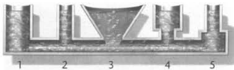
Figura 13.5 Paradoja hidrostática. El nivel del agua es el mismo en todos los recipientes con independencia de su forma. La porción sombreada del agua es soportada por las paredes laterales del recipiente.
