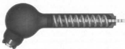
Medidor de la presión para neumáticos. El pistón presiona la varilla hacia la derecha hasta que la fuerza del muelle más la fuerza de la presión atmosférica se equilibra con la fuerza ejercida por la presión del aire del interior del neumático.
