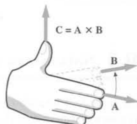
Figura 10.6 La dirección de A \times B viene dada por la regla de la mano derecha cuando los dedos giran desde A hacia B a lo largo del ángulo \phi .
