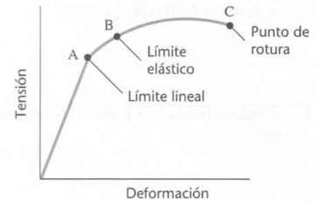
Figura 12.21 Tensión en función de la deformación. Hasta el punto A la deformación es proporcional a la tensión. El punto B, límite elástico, es el punto a partir del cual la barra no recuperará su longitud original cuando se suprima la tensión. En el punto C la barra se rompe.
