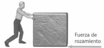
Figura 4.4 La fuerza de rozamiento ejercida por el suelo sobre el bloque se opone a su desplazamiento o a su tendencia a deslizar.
