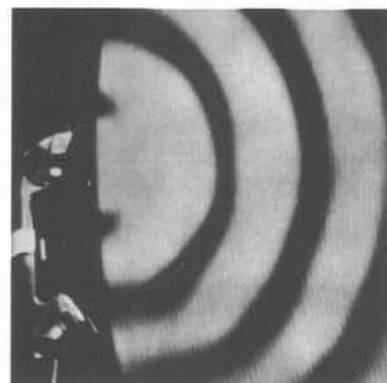
Ondas sonoras procedentes de un receptor telefónico propagándose en el aire. Las ondas se han hecho visibles barriendo el espacio delante del receptor con una lámpara que tiene un brillo controlado mediante un micrófono.
