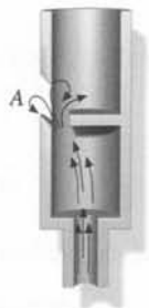
Figura 16.17 Tubo de órgano de lengüeta. Se sopla una corriente de aire contra el borde originando un movimiento turbulento del aire cerca de A que excita ondas estacionarias en el tubo. Existe un nodo de presión cerca del punto A, que está abierto a la atmósfera.
