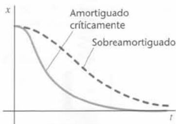
Figura 14.21 Representación gráfica del desplazamiento en función del tiempo en el caso de un oscilador amortiguado críticamente y otro sobreamortiguado.
