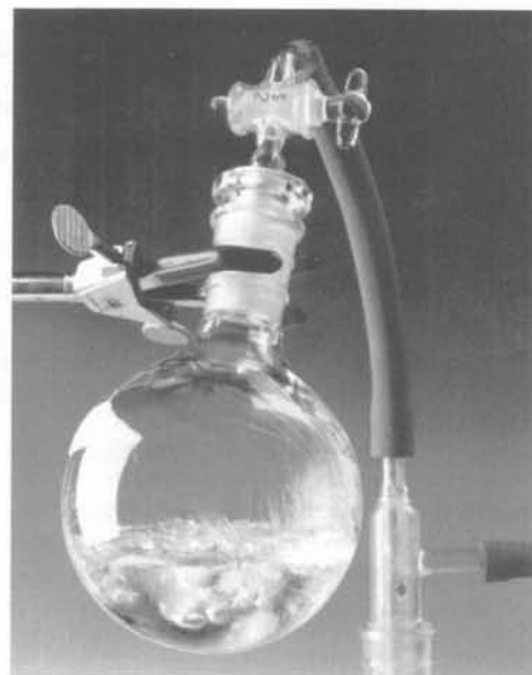
Figura 17.7 \text{H}_2\text{O} en su punto triple. Contiene agua, hielo y vapor de agua, todo en equilibrio.
