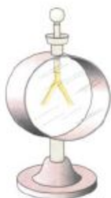
Figura 18-3 Electroscopio. Las dos hojas de oro se conectan a una barra metálica terminada en la parte superior por una esfera de metal. Cuando una carga negativa se deposita sobre la bola metálica, es conducida a las hojas y éstas se repelen entre sí.
