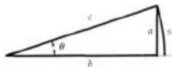
Figura A-16 En el caso de ángulos pequeños, \sin \theta = a/c , \operatorname{tg} \theta = a/b y el ángulo \theta = s/c son todos ellos aproximadamente iguales.
