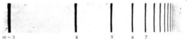
Figura 35-10 Serie de Balmer para la luz emitida desde el hidrógeno. Las longitudes de onda de estas líneas vienen dadas por la ecuación 35-14 para diferentes valores del número entero m .
