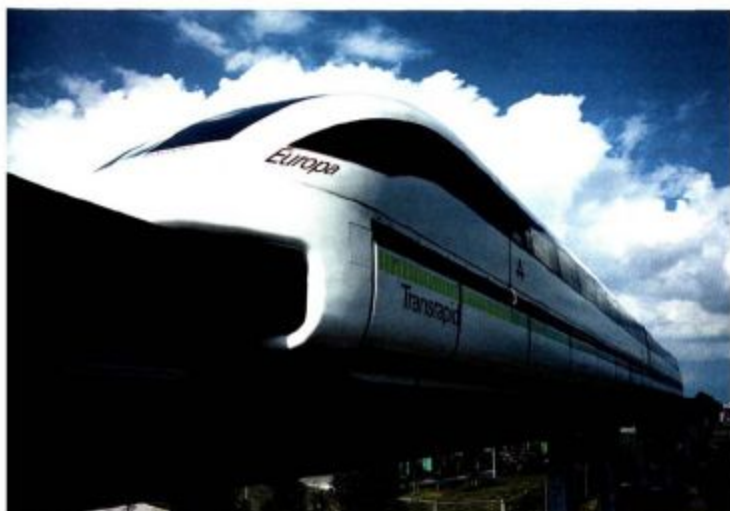
Este tren experimental Maglev que utiliza la repulsión magnética para la levitación, guía y propulsión, alcanza velocidades superiores a 300 km/h.
