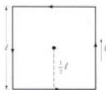
Figura 25-16 Espira de corriente cuadrada correspondiente a los datos del ejemplo 25-5.
