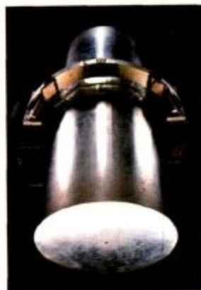
Esta antena, formada por un cilindro de aluminio de 1400 kg colgada libremente de un cable de acero, fue construida por Joseph Webber, David Zippy y Robert Foward en la Universidad de Maryland para detectar las ondas gravitatorias. En teoría, la antena debería vibrar cuando las ondas de gravedad pasaran por ella.
