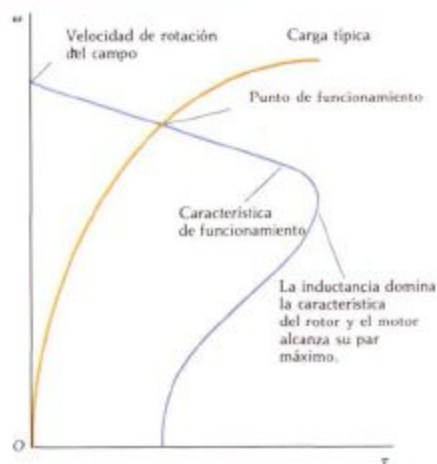
Figura 13 Representación gráfica del par en función de la velocidad donde se muestra la característica de funcionamiento de un motor de inducción típico. La línea de carga indicada es típica de una bomba centrífuga.
