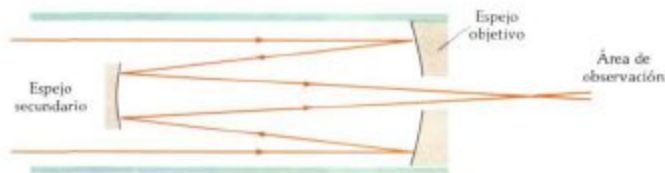
Figura 32-11 Telescopio reflector con un espejo secundario para dirigir la luz de forma que atraviese un pequeño orificio existente en el espejo objetivo. Esta
