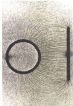
Líneas de fuerza en el caso de un cilindro y una placa con cargas opuestas. Las líneas están indicadas por trocitos de hilo fino suspendidos en aceite. Obsérvese que las líneas de campo son perpendiculares a los conductores y que no hay ninguna línea en el interior del cilindro.
