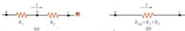
Figura 22-14 (a) Dos resistencias en serie transportan la misma corriente. (b) Las resistencias de la parte (a) pueden sustituirse por una resistencia equivalente sencilla R_{\text{eq}} = R_1 + R_2 , que da la misma caída de potencial total cuando circula la misma corriente que en la parte (a).
