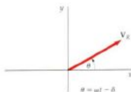
Figura 28-8 La tensión aplicada a una resistencia puede representarse mediante un vector V_R denominado fasor, que tiene de módulo el valor I_{max}R y que forma un ángulo \theta = \omega t - \delta con el eje x . El fasor rota con una frecuencia angular \omega . La tensión V_R = IR es el componente x de V_R .
