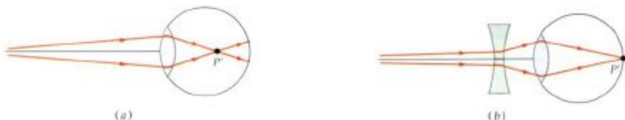
Figura 32-3 (a) Un ojo miope enfoca los rayos procedentes de un objeto lejano en un punto P' situado delante de la retina. (b) Una lente divergente corrige este defecto.
