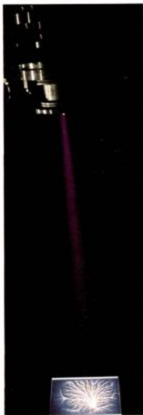
Un haz de 1000 A de electrones de 3 MeV, choca contra una placa de lucita. La placa adquiere una carga y se descarga produciendo el espectacular diagrama que muestra la fotografía. El haz de electrones que dura aproximadamente 1 \mu\text{s} , ioniza las moléculas de aire, las cuales producen un resplandor azulado al recombinarse.
