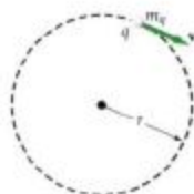
Figura 27-5 Partícula de carga q y masa m_q moviéndose en un círculo de radio r . El momento angular está dirigido hacia el papel y su magnitud es m_q v r ; el momento magnético está dirigido hacia el papel (si q es positivo) y su magnitud es \frac{1}{2} q v r .
