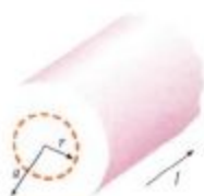
Figura 25-22 Conductor largo de radio a que transporta una corriente I uniformemente distribuida en su área transversal. Debido a su simetría, el campo magnético a cualquier distancia r puede calcularse aplicando la ley de Ampère a una circunferencia de radio r .
