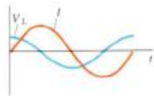
Figura 28-5 La corriente y la tensión que circula y se aplica a la bobina de la figura 28-4 en función del tiempo. La tensión máxima aparece un cuarto de período antes de que se presente el máximo de la corriente. Así pues, se dice que la tensión adelanta a la corriente en un cuarto de período o 90^\circ .
