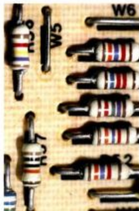
Resistencias de carbón con el código de color sobre un panel de circuitos.
