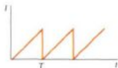
Figura 28-3 Onda en forma de diente de sierra correspondiente a la corriente del ejemplo 28-1.
