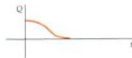
Figura 28-14 Gráfico de Q en función de t para el circuito LCR de la figura 28-12 cuando R es tan grande que las oscilaciones están sobreamortiguadas.
