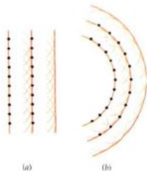
Figura 30-6 Construcción de Huygens para la propagación hacia la derecha de (a) una onda plana y (b) una onda esférica o circular de partida.
