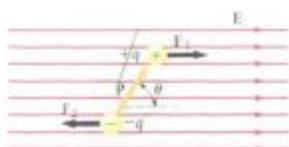
Figura 18-24 Un dipolo en un campo eléctrico uniforme experimenta fuerzas iguales y opuestas que tienden a girar el dipolo, de modo que su momento dipolar tiende a alinearse con el campo eléctrico.
