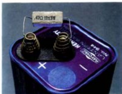
Figura 22-11 Fotografía de un circuito simple formado por una batería real, una resistencia y cables de conexión.
