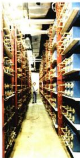
Banco de condensadores para almacenar energía en el láser de impulsos Nova utilizado en los Lawrence Livermore Laboratories para el estudio de la fusión. Cada condensador posee una capacidad de unos 20 \mu\text{F} .
