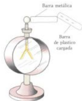
Figura 18-4 Una barra metálica está en contacto con la esfera de metal del electroscopio. Al tocar el extremo de la barra con otra de plástico cargada negativamente, parte de la carga es conducida a lo largo de la barra metálica al electroscopio, como evidencia la separación de las hojas de oro.
