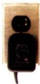
Transformador y rectificador para convertir la corriente de 120 \text{ V} ca de un enchufe de pared a 9 \text{ V} cc para su empleo en conexión con una radio o una calculadora, con objeto de ahorrar pilas.
