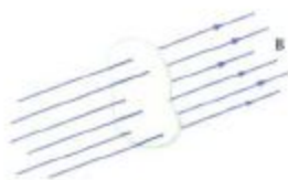
Figura 26-2 Cuando el campo magnético \mathbf{B} es perpendicular al área cerrada por un bucle, el flujo magnético que atraviesa éste es BA .
