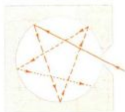
Figura 35-1 Cavidad con la que puede aproximarse un cuerpo negro ideal. La radiación que entra en la cavidad tiene una probabilidad muy pequeña de salir de la misma. Normalmente se absorbe por completo.
