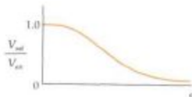
Figura 28-22 Gráfico del cociente entre la tensión de salida y la de entrada en función de la frecuencia \omega . Este circuito recibe el nombre de filtro pasa baja RC , porque se transmiten con mayor amplitud las frecuencias bajas de entrada que las altas.
