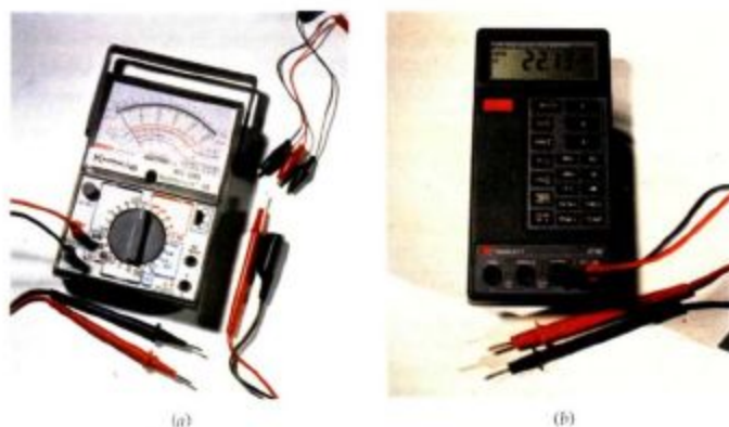
(a) Multímetro analógico. (b) Multímetro digital. Generalmente los multímetros digitales son más exactos y más caros que los analógicos.
