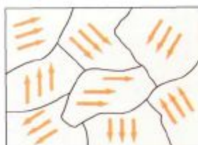
Figura 27-8 Ilustración esquemática de los dominios ferromagnéticos. Dentro de un dominio, los dipolos magnéticos están alineados, pero la dirección de alineamiento varía de un dominio a otro, de modo que el momento magnético neto es nulo. Un pequeño campo magnético externo puede causar el ensanchamiento de aquellos dominios que se alinean paralelamente al campo, o producir la rotación de la dirección de alineamiento dentro del dominio. En cualquier caso, el resultado es un momento magnético paralelo al campo.
