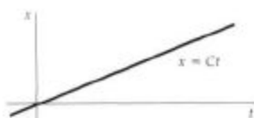
Figura A-22 Representación de la función lineal x = Ct . Esta función tiene una pendiente constante C .
