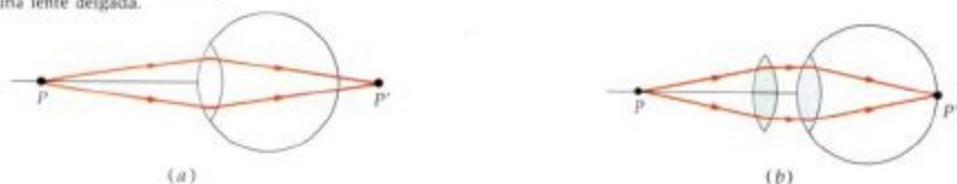
Figura 32-2 (a) Un ojo hipermetrope enfoca los rayos procedentes de un objeto P cercano en un punto P' detrás de la retina. (b) Una lente convergente corrige este defecto desplazando la imagen de forma que caiga sobre la retina. Estos diagramas y los siguientes se han dibujado como si todo el efecto de enfoque del ojo lo realizase el cristalino; de hecho, el sistema córnea-cristalino actúa más como una superficie esférica refractora que como una lente delgada.
