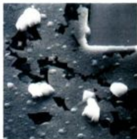
Esta fotografía (obtenida con un microscopio electrónico de barrido) de una lámina conductora de aluminio de 21 \mu\text{m} de anchura, como las utilizadas en los «chips» de los ordenadores, muestra huecos y conglomerados de átomos formados por electromigración de átomos de aluminio a causa de una corriente de 0,5 A. La naturaleza de este efecto no está bien comprendida, pero afecta negativamente a la fiabilidad de los «chips» del ordenador, que usan láminas de un espesor de 4 \mu\text{m} .
