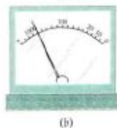
Figura 23-30 (a) Ohmímetro formado por una batería en serie con un galvanómetro y una resistencia R_s elegida de tal modo que el galvanómetro se desvía a fondo de escala cuando los puntos a y b están en cortocircuito. (b) Escala del galvanómetro calibrada para hacer lecturas en ohmios.
