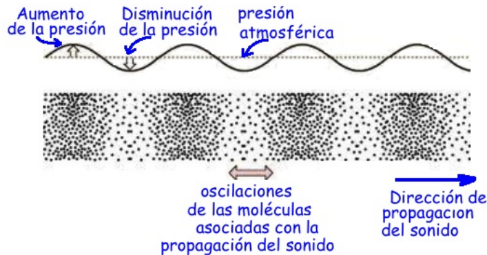
Figura I.1: Propagación del sonido en un tubo. Las zonas de alta densidad (las más oscuras) corresponden a la mayor presión. Esta sobre-densidad se propaga hacia la derecha reemplazando a las zonas de densidad más baja. El volumen en cada tramo del tubo se comprime y descomprime pero las partículas de gas NO se trasladan hacia la derecha. la energía se traslada, no las partículas.
