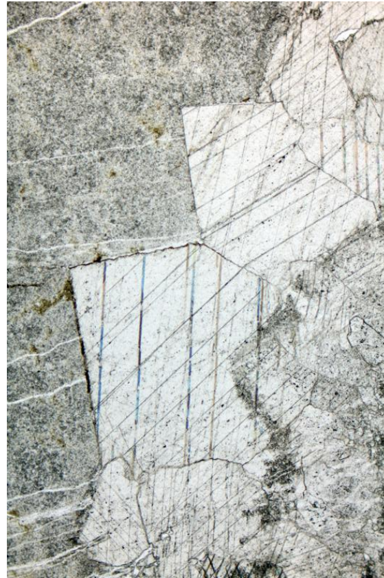
Imagen a NP. Fractura rellena por calcita. Lado mayor de la imagen = 7mm
