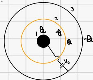
Para simplificarme la vida en este problema diré que el conductor 1 tiene carga  $Q$ . Por lo que el campo eléctrico para  $a < r < b$ :
