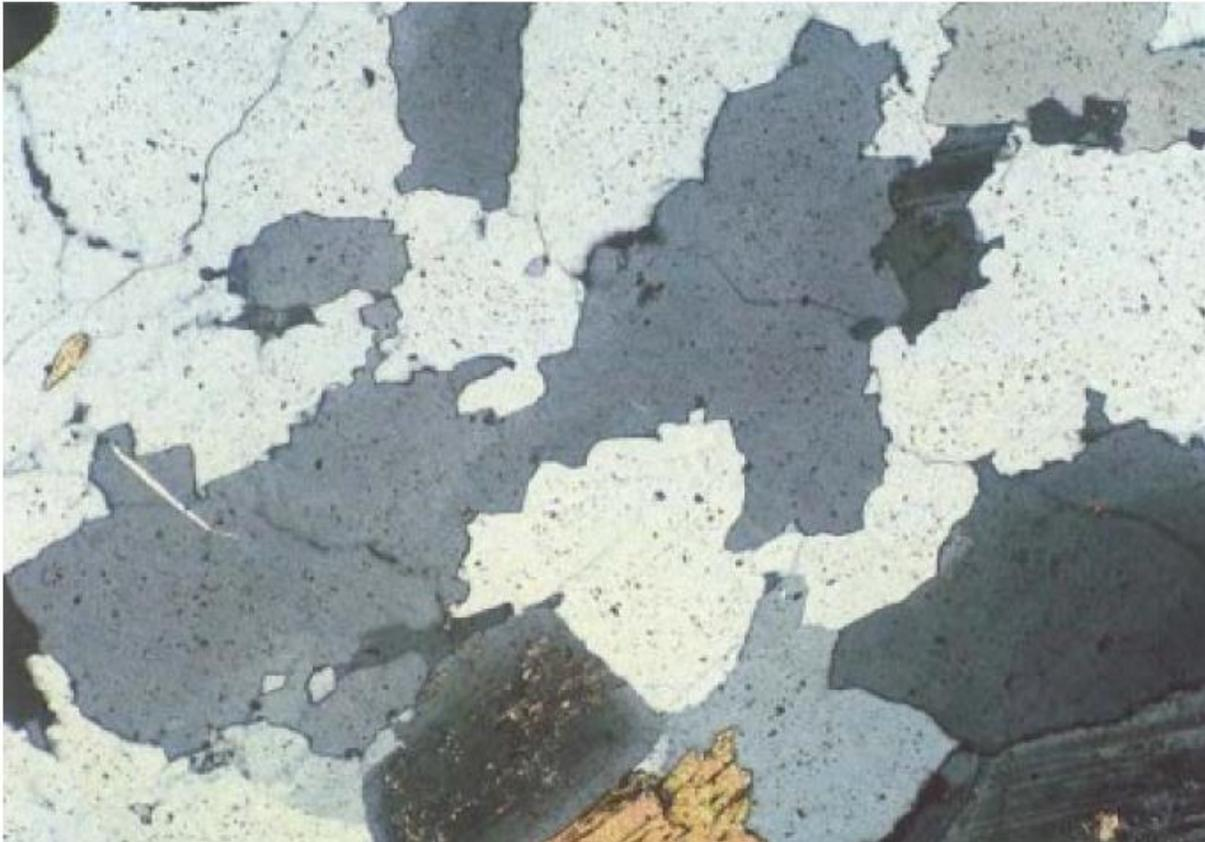
Interdigitación entre los bordes de cristales que da como resultado un aspecto aserrado de los contactos.
